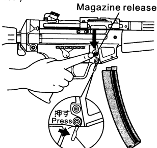
マガジンキャッチレバー Magazine catch lever
